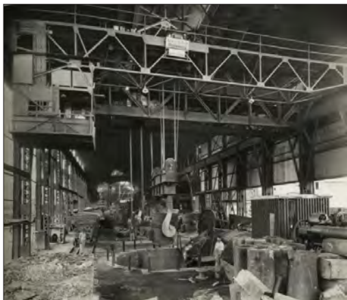
Figura 37. Grúa DEMAG levantando crisol, después que el Mezclador vaciara el acero líquido, 1930. Eugenio Espino Barros. Monterrey, N.L., México. DR. ©Fototeca Nuevo León – CONARTE, Fondo: Fundidora.
