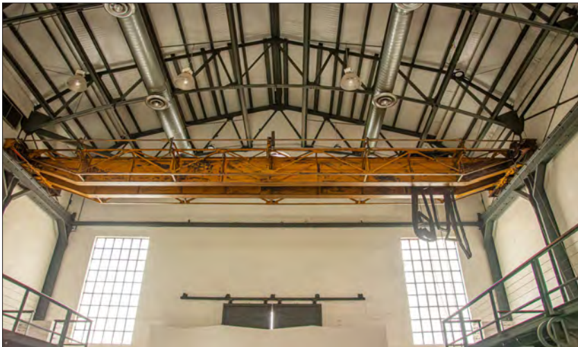
Figura 42. Interior del Pabellón Mitsubishi con grúa viajera de 20 Tons., restaurada en 2006-2007. Fotografía: Iván Montalvo. 2023.
