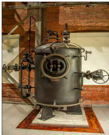
Figura 35. Boiler de las Calderas M.A.N. 1932. Pieza patrimonial ubicada en Edificio Ingenios de Soplo del Horno Alto N° 1. –Parque Fundidora, Monterrey, N.L. 2022.
