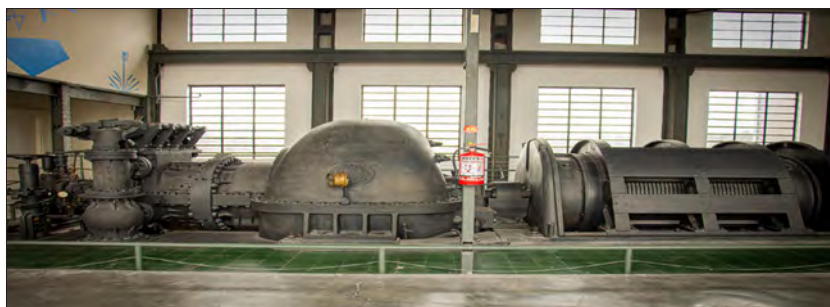
Figura 22. Máquina sopladora G.E. de 6 000 KW ubicada en Nave Generadores/Conarte, interior Parque Fundidora. Fotografía: Iván Montalvo, 2023.
