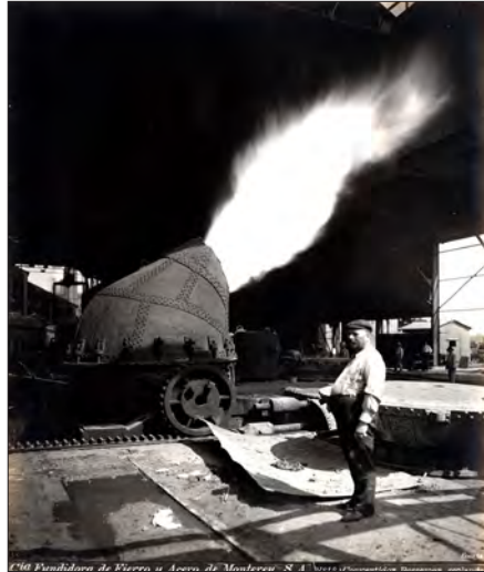
Figura 30. N° 12. Convertidor Bessemer soplando. 1909. Guillermo Kahlo. Monterrey, N.L., México. N° Inv. 51549 D.R. ©Fototeca Nuevo León – CONARTE, Fondo: Fundidora..
